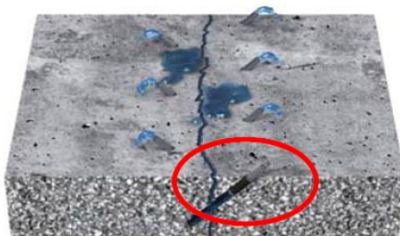
شکل ۱۷ : نمایی از نصب بر روی اولین پکر
