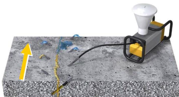
شکل ۲۰: نحوه تزریق با پایش های لازمه
